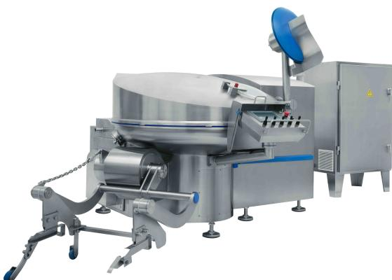
ZBZ-200III – модель высокоскоростного вакуумного куттера с односкоростным асинхронным двигателем и частотным преобразователем для плавного пуска и остановки ножевого вала. Количество скоростей – 4, от 750 до 4500 об/мин. Вращение чаши выполняет второй асинхронный двигатель с преобразователем частоты. Объем рабочей чаши – 200 л, материал изготовления – пищевая нержавеющая сталь.
