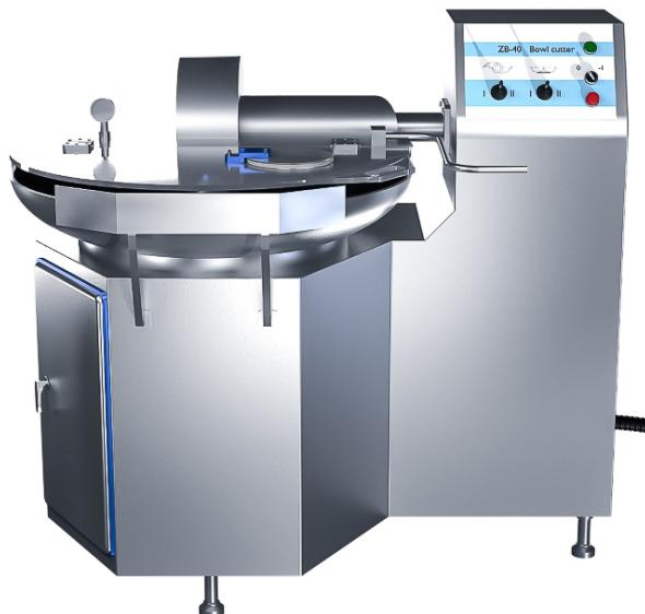
Куттер ZBG20 представляет собой наиболее компактную модель серии открытых (невакуумных) куттеров ZBG. Особенностью серии является комплектация двигателем повышенной мощности и высокая скорость вращения ножей (4 ступени) – до 4500 об/мин. Частотный преобразователь обеспечивает плавное переключение скоростей.
