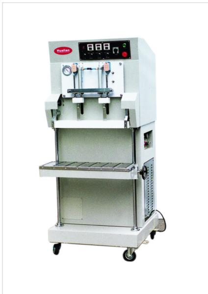
Вакуумный упаковщик DZQ-1000L/S – модель с максимальной длиной запаечной планки (1000 мм) среди бескамерных вакуум-упаковочных машин промышленного типа DZQ-L/S. Особенностью серии является наличие опции двойного нагрева запаечных планок для надежного запечатывания материалов большой плотности, двойной нагрев обозначает, что нагрев идет одновременно и сверху, и снизу.
