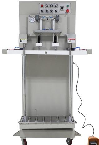
Бескамерный вакуумный упаковщик DZQ-1000L – современное промышленное оборудование для упаковки в вакуумную и газовую среду. Особенностью серии DZQ-L является наличие регулируемого по высоте конвейера с рольгангами. Соответственно можно настроить необходимое положение конвейера под различную высоту пакета. Длина запечной планки составляет 1000 мм, а ширина шва 10 мм, высокое качество запайки обеспечивается пневматической системой прижима губок.
