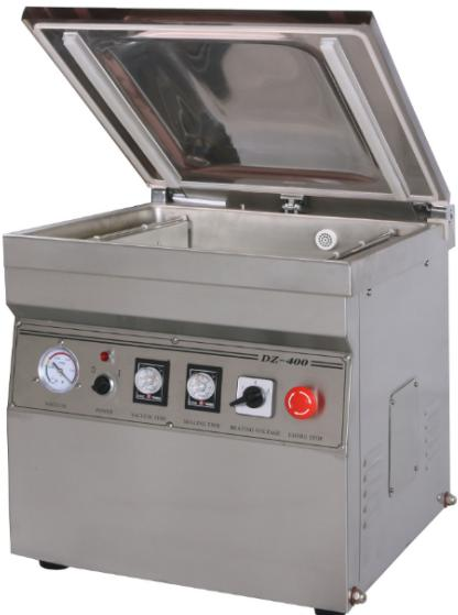
Представляемый вакуумный упаковщик HVC-400/2T-G (DZQ-400/2T) с функцией газонаполнения выполнен в корпусе из нержавеющей стали. Оснащен промышленным вакуумным насосом производительностью 20 м<sup>3</sup> /час.
